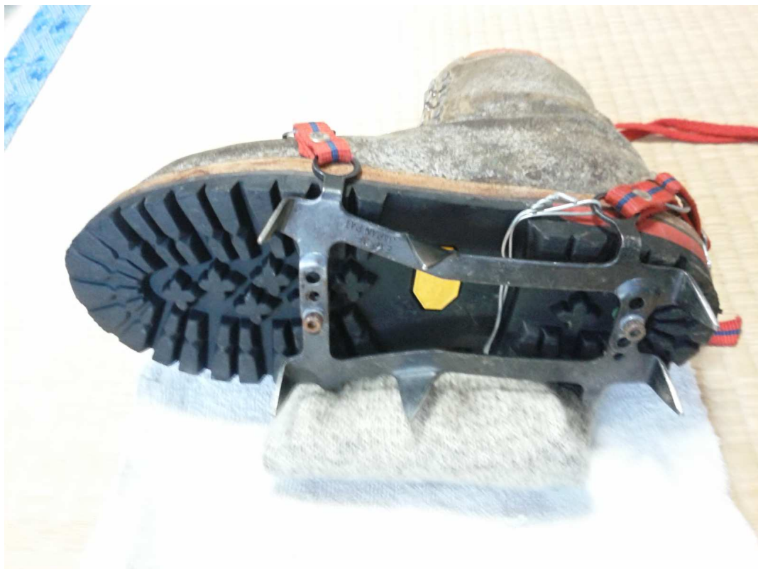
おまけ、6本爪アイゼン改造。ガタつき防止で針金を付けて、ヒール部に引っ掛ける。
